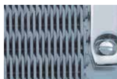
Цапфы, приваренные лазером, с клёпаными деталями
